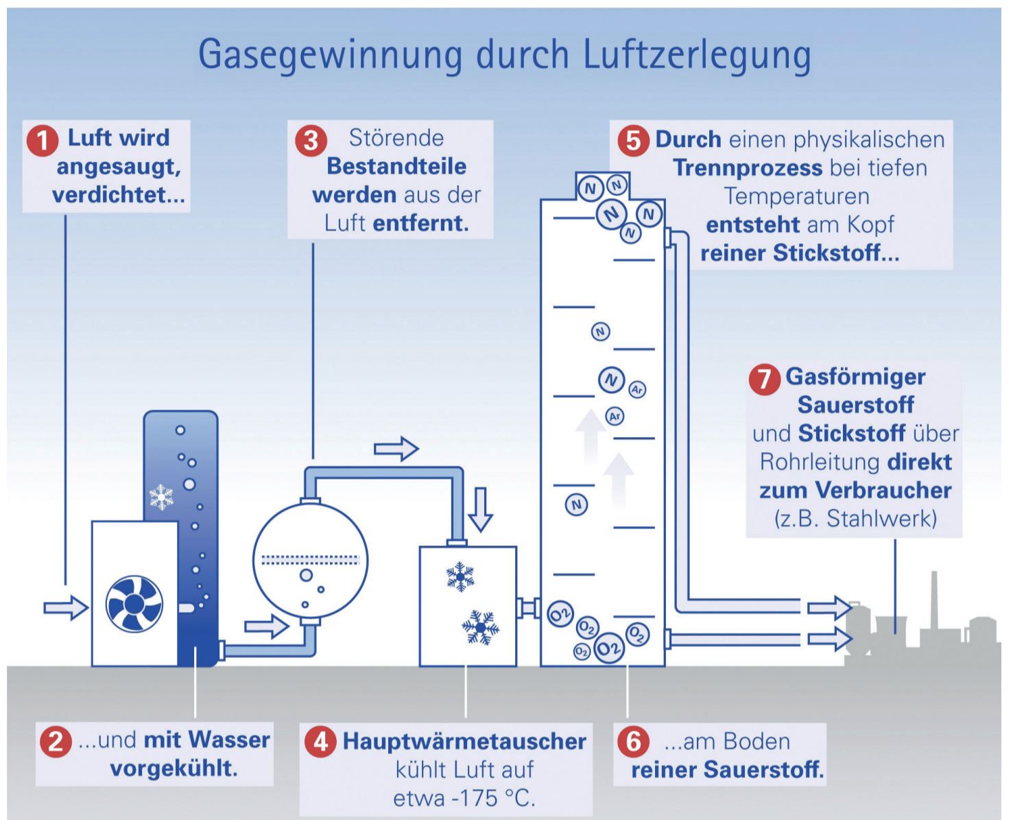
Die Grafik zeigt den Prozess von der unfiltrierten Umgebungsluft bis zum reinen Stickstoff, Sauerstoff und Argon bei Messer Schweiz in Lalden.
