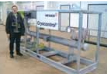
Eine Cryocontrol®-Anlage von Messer zur Reaktorkühlung wurde für den ungarischen Pharmaproduzenten Richter Gedeon entwickelt.
