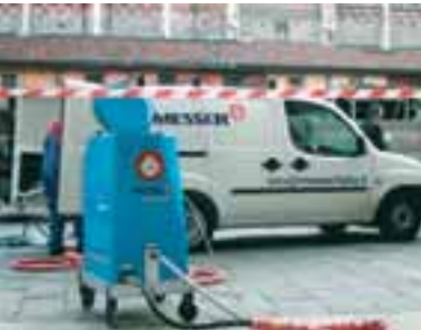
Der Steinboden im historischen Stadtkern von Ferrara wurde mit dem Trockeneis-Strahlverfahren von Messer von Kaugummi befreit.
