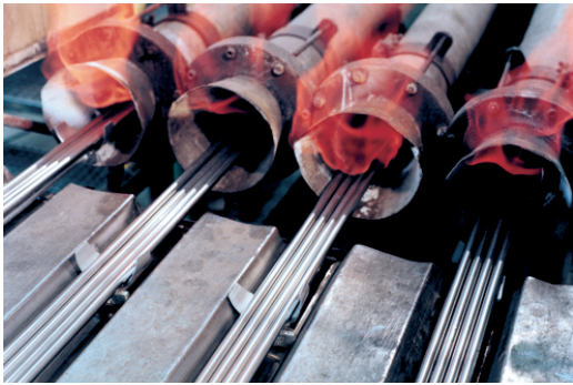
Kaljenje posebne žice v peči za nenehno žarjenje.
